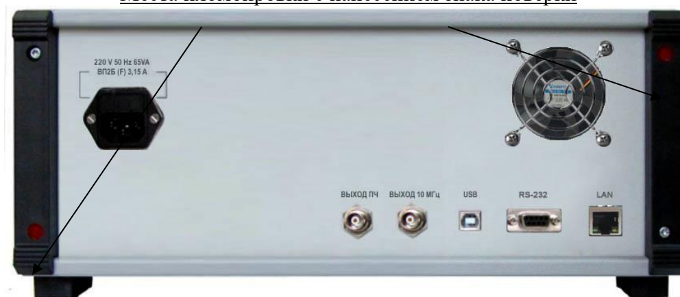
Рисунок 2 – Схема пломбировки от несанкционированного доступа, обозначение мест нанесения знака поверки
