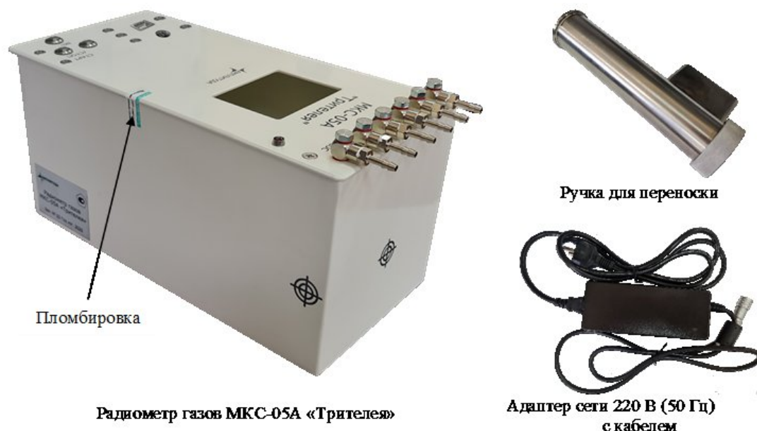
Рисунок 1 – Общий вид радиометра и схема пломбировки от несанкционированного доступа
