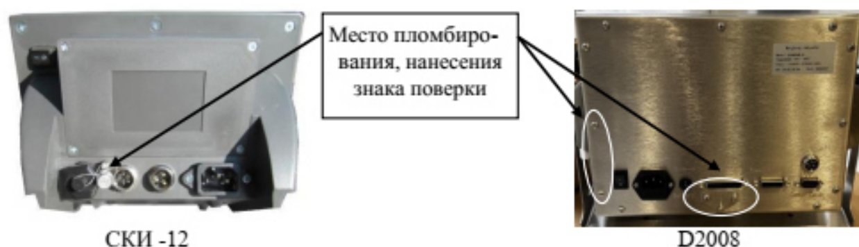
Рисунок 3 – Схема пломбировки от несанкционированного доступа, место нанесения знака поверки для весов автомобильных ПВТ
