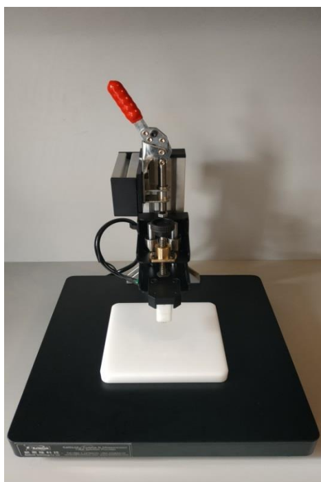
Рисунок 2 – Манипулятор с ручным позиционированием измерительной головки рычажного типа
