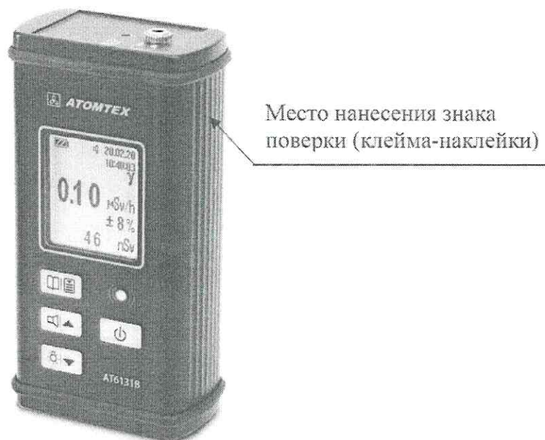
Рисунок 2 – Место нанесения знака поверки (клейма-наклейки)
