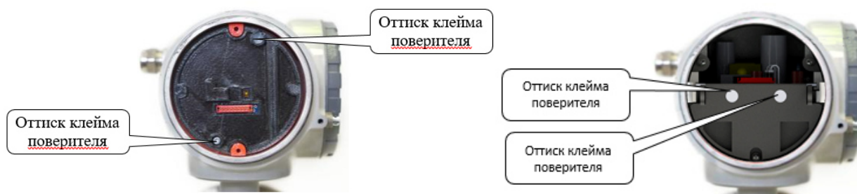
Рисунок 4 – Места нанесения знака поверки на ИП расходомера-счётчика Питерфлоу Т модификации 3
