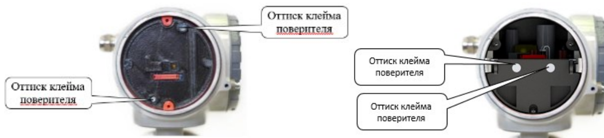
Рисунок 4 – Места нанесения знака поверки на ИП расходомера-счётчика Питерфлоу Т модификации 3
