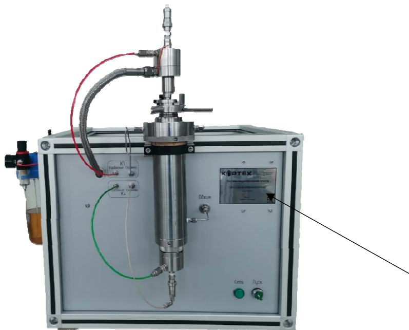
Рисунок 1 – Общий вид установки для измерения пористости и проницаемости СМП-ППП без манометра входного давления с указанием места нанесения маркировки
