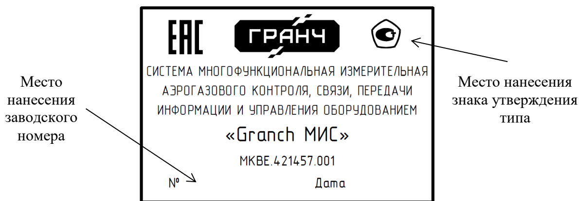
Рисунок 1 – Место нанесения заводского номера и знака утверждения типа
