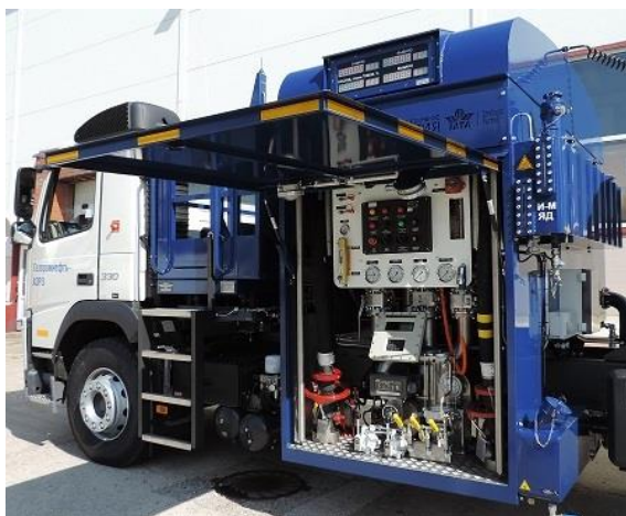
Рисунок 1 – Общий вид системы спереди на средстве заправки
