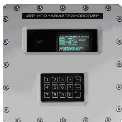
Рисунок 6 – Пульта управления специальным контроллером (ПУСК-01)
