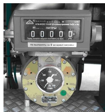
Рисунок 7 – Счетчик жидкости лопастной МКА (Master)
