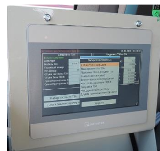
Рисунок 5 – Панель оператора сенсорная (ПОС-10)
