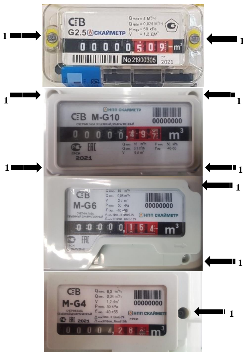
Рисунок 3 – Схема пломбировки от несанкционированного доступа, обозначения места нанесения знака поверки счетчиков газа диафрагменных СГВ в исполнении «СГВ-VM» и «СГВ-МТ» (1 – место для установки знака поверки)
