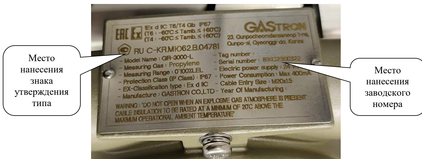
Рисунок 3 – Общий вид таблички с маркировкой газоанализаторов (на примере GIR-3000-L)
