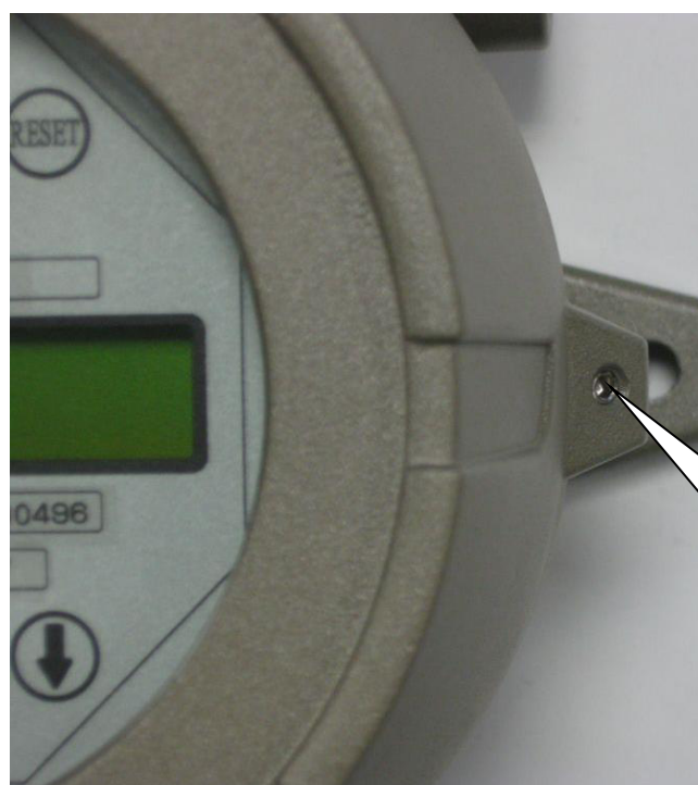
Рисунок 2 – Схема пломбирования газоанализаторов (на примере GIR-3000-L)
