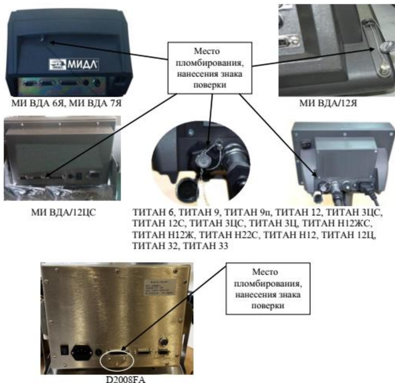
Рисунок 3 – Схема пломбировки от несанкционированного доступа, место нанесения знака поверки для весов автомобильных АСП
