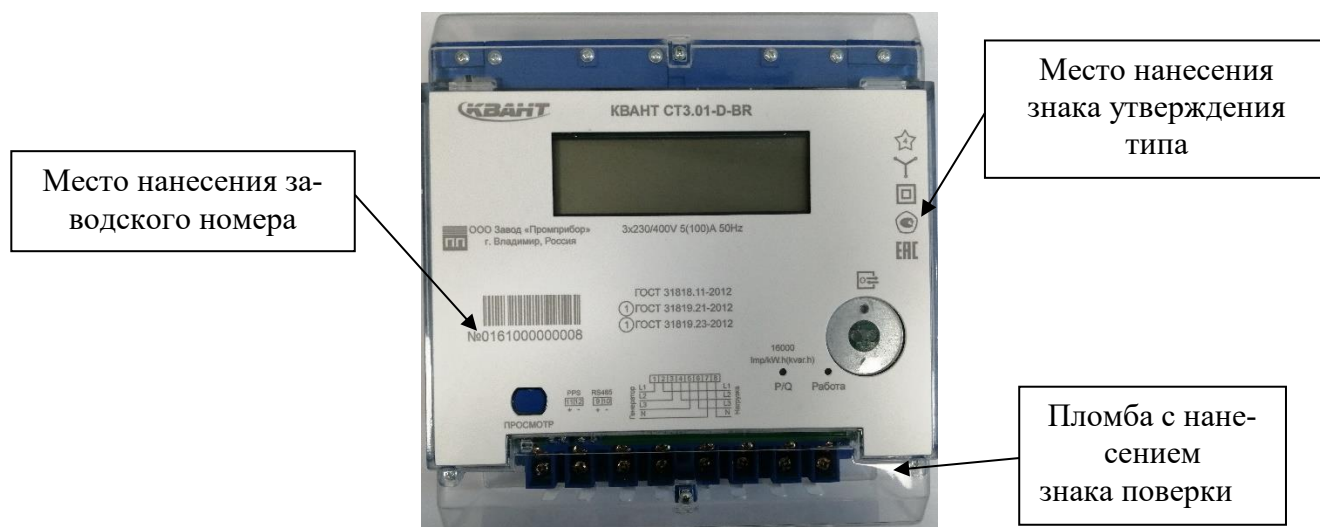
Рисунок 1 – Общий вид счетчиков модификации 01 в корпусе типа W и D с указанием места ограничения доступа к местам настройки (регулировки), места нанесения знака утверждения типа, места нанесения заводского номера
