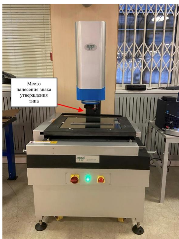
Рисунок 2 – Общий вид микроскопов видеоизмерительных Jaten модификаций QA3020CNC, QA4030CNC, QA5040CNC
