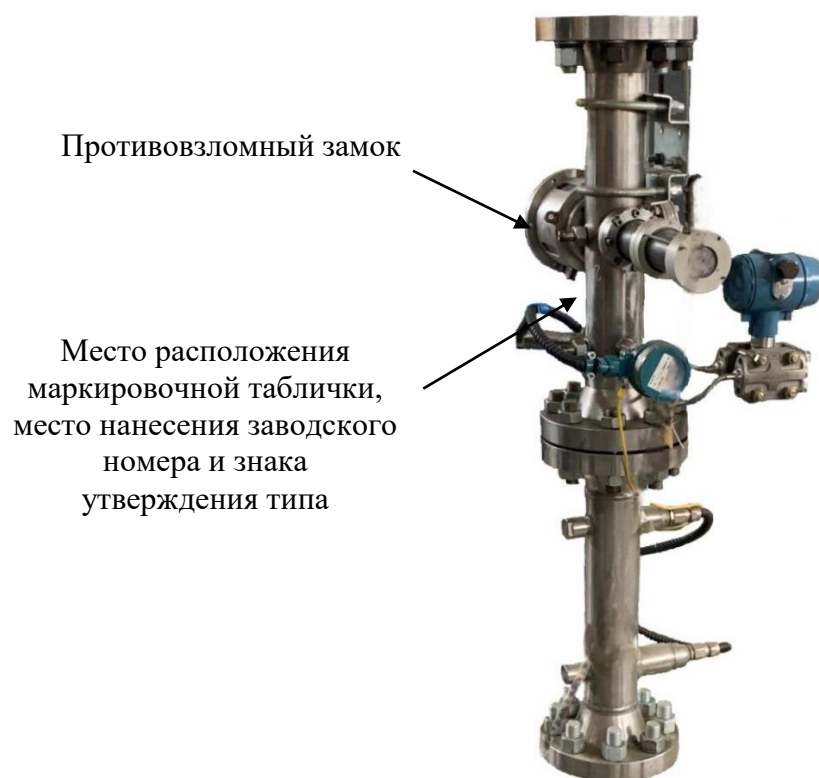
Рисунок 1 – Общий вид измерительного модуля расходомера многофазного Система-1
