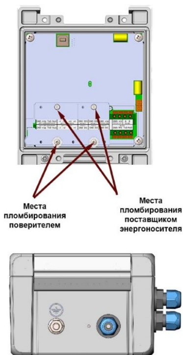
в) модификация ВКТМ.3 с выносным датчиком давления (пломбировка вычислительного устройства)
