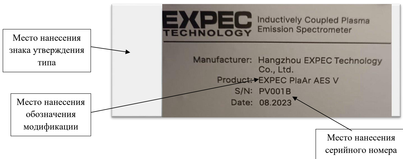
Рисунок 4 – Вид информационной таблички (шильды) с указанием мест нанесения серийного номера и знака утверждения типа
