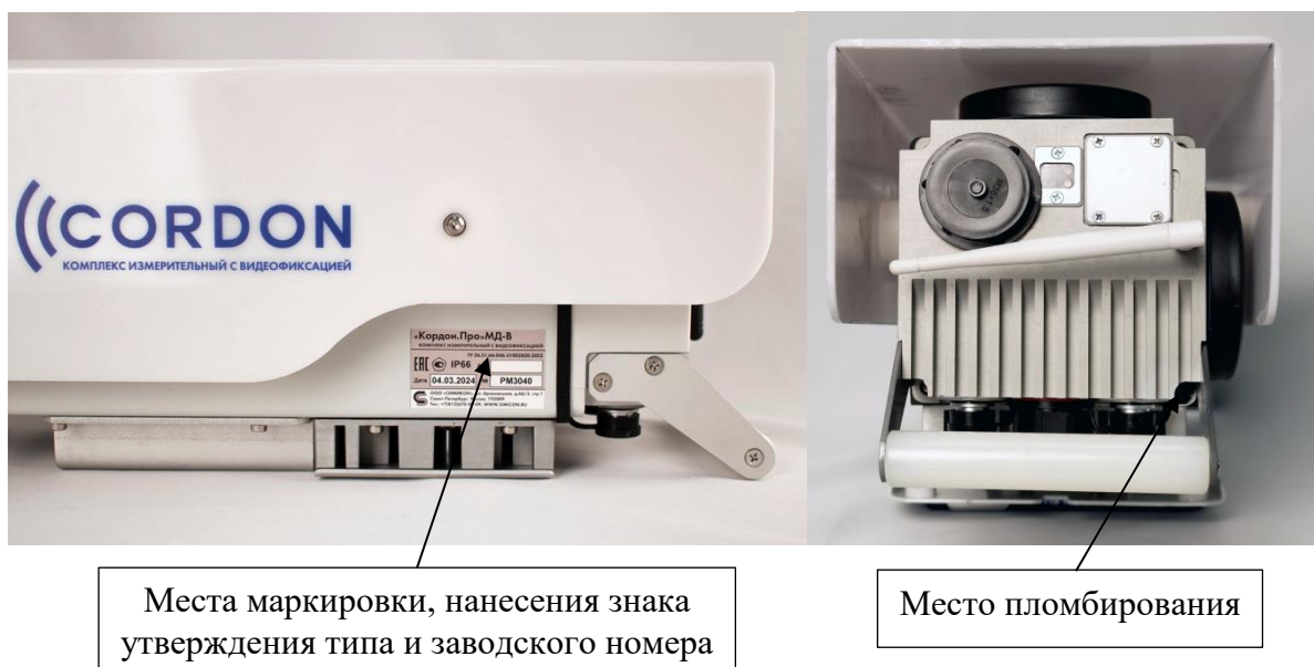
Рисунок 3 – Места пломбирования, маркировки, нанесения знака утверждения типа и заводского номера
