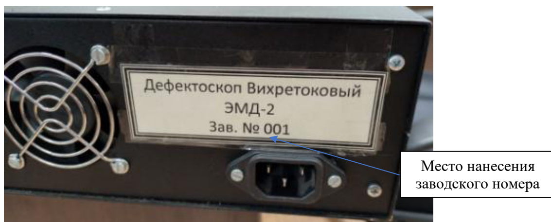
Рисунок 2 – Обозначение места нанесения заводского номера
