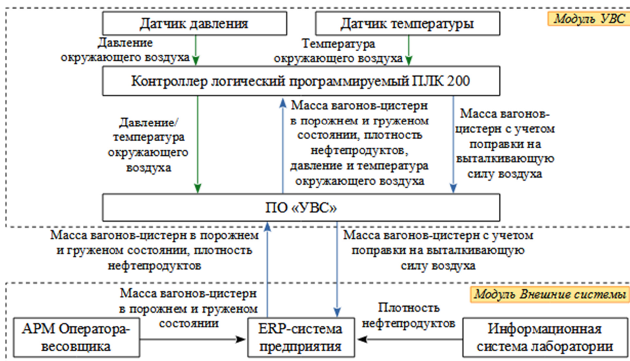
Рисунок 1 – Схема информационных потоков при выполнении измерений
