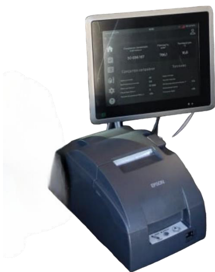
Рисунок 4 – Общий вид модуля с контроллером SFAuto и принтером
