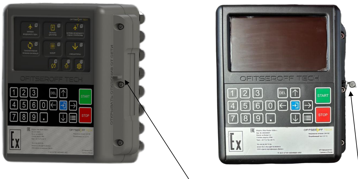
Место установки пломбы на дозирующем контроллере
