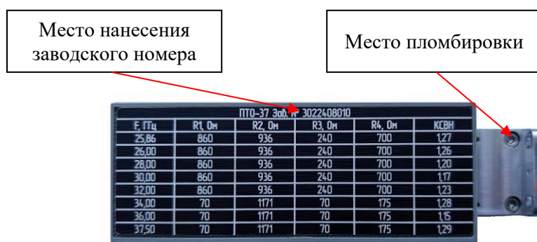
Рисунок 5 – Место нанесения заводского номера и пломбировки на преобразователи термисторные оконечного типа
