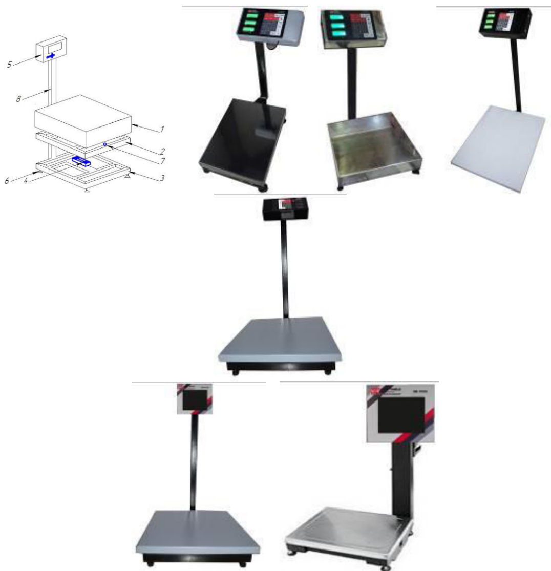
б) общий вид весов ВЕР-TORG-[М]-П-[Д] напольного исполнения со стойкой с одним датчиком (1 – грузоприемная платформа; 2 – верхняя опорная рама; 3 – нижняя опорная рама; 4 – датчик; 5 – прибор весоизмерительный; 6 – регулируемая опора; 7 – пузырьковый уровень; 8 – стойка)
