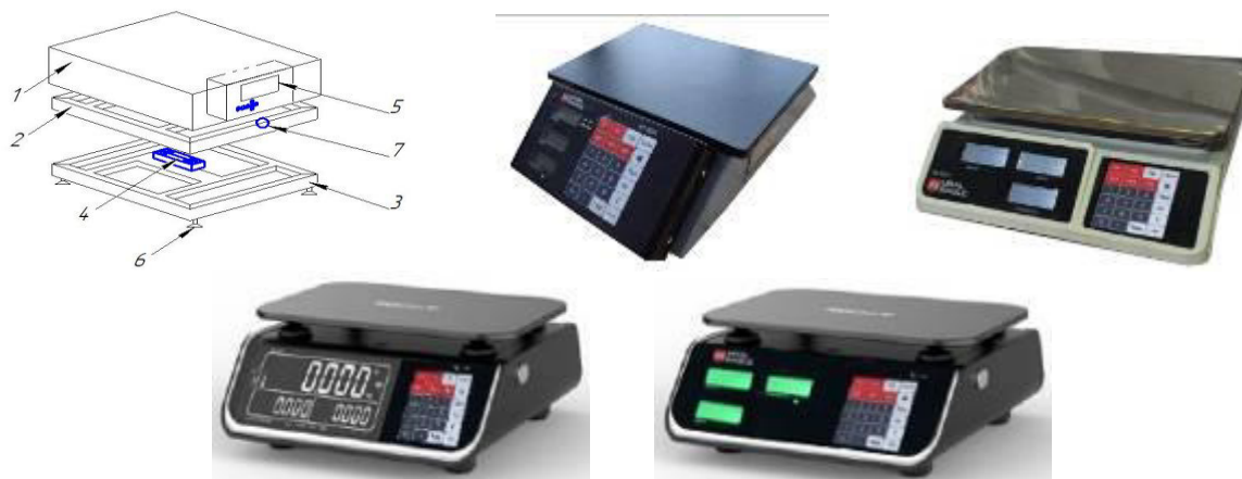
а) общий вид весов ВЕР-TORG-[М]-С-[Д] настольного исполнения с одним датчиком (1 – грузоприемная платформа; 2 – верхняя опорная рама; 3 – нижняя опорная рама; 4 – датчик; 5 – прибор весоизмерительный; 6 – регулируемая опора; 7 – пузырьковый уровень)
