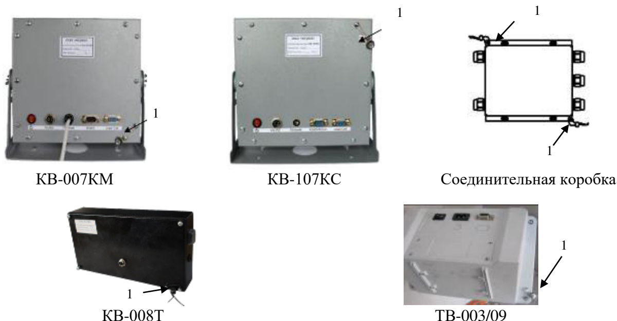
Рисунок 4 – Схема пломбировки приборов весоизмерительных (1 – свинцовая, пластиковая или мастичная пломба)
