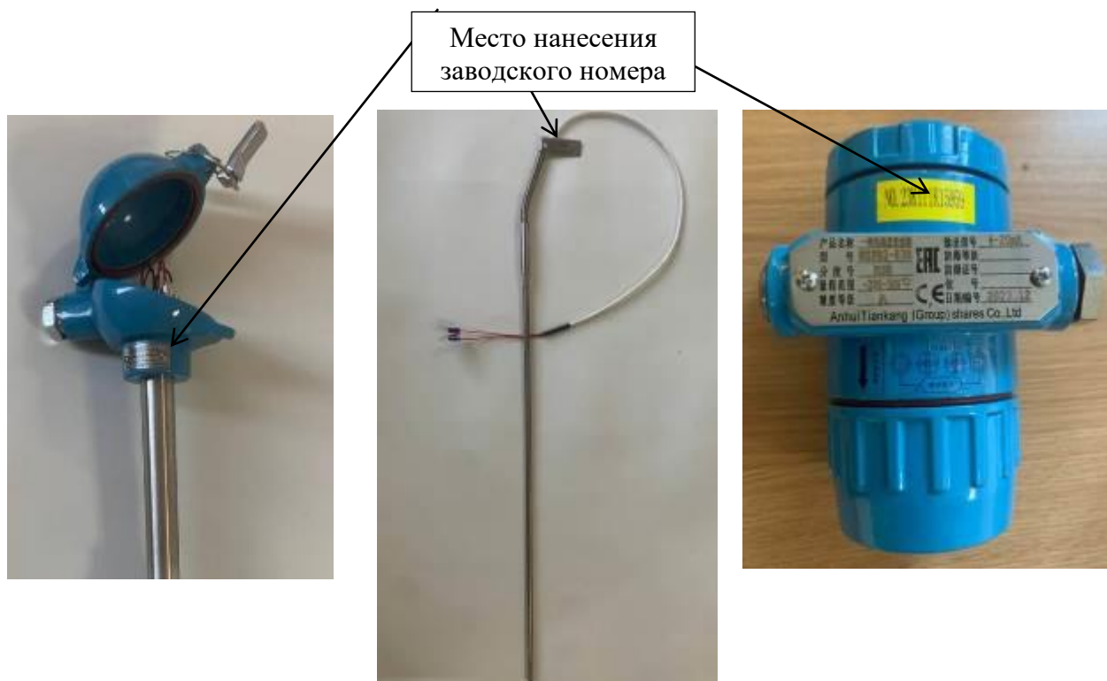
Рисунок 7 – Общий вид ТС с указанием мест нанесения заводского номера
