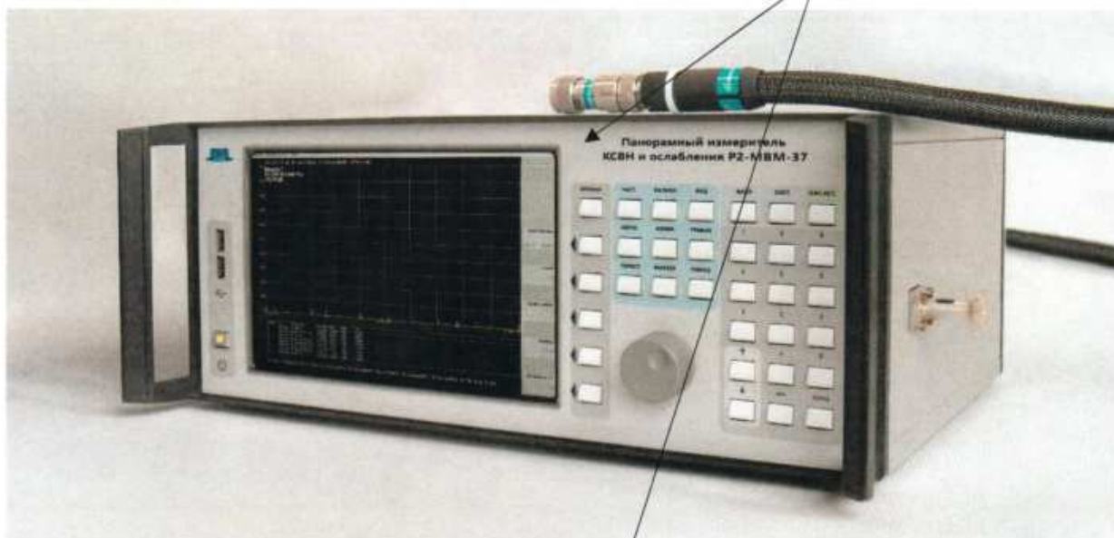
а) Панорамный измеритель КСВН и ослабления P2-MBM-37
