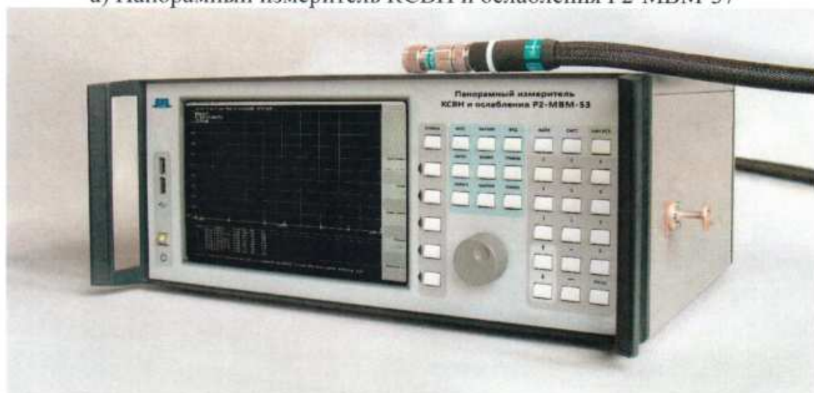
б) Панорамный измеритель КСВН и ослабления P2-MBM-53
