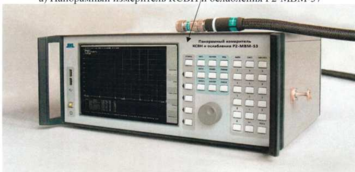
б) Панорамный измеритель КСВН и ослабления P2-MBM-53
