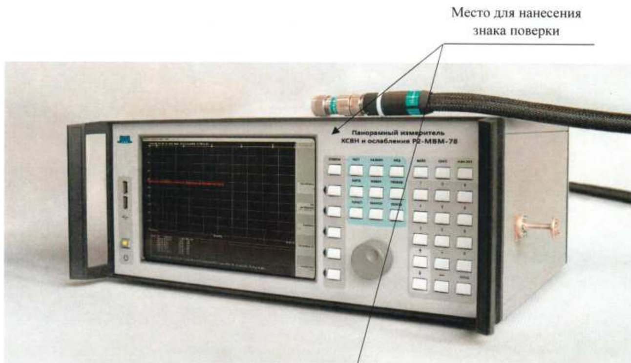
в) Панорамный измеритель КСВН и ослабления P2-MBM-78
