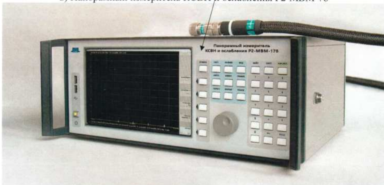
г) Панорамный измеритель КСВН и ослабления P2-MBM-178
