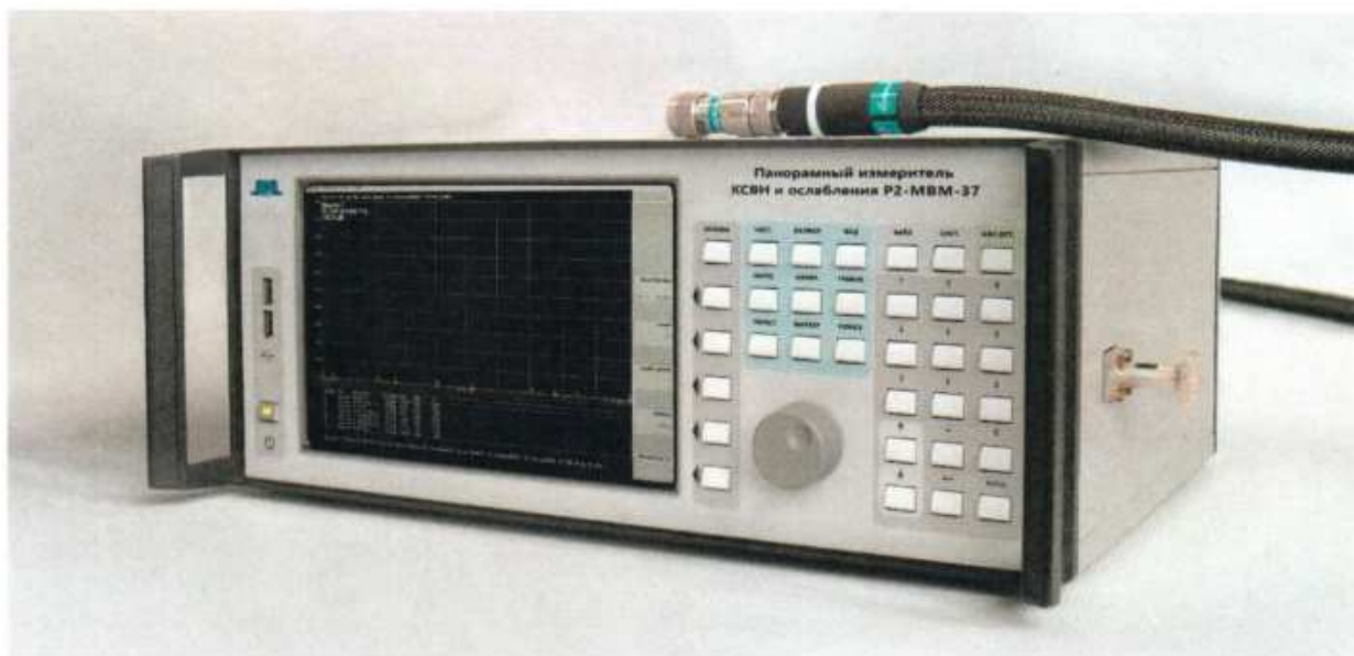
а) Панорамный измеритель КСВН и ослабления P2-MBM-37
