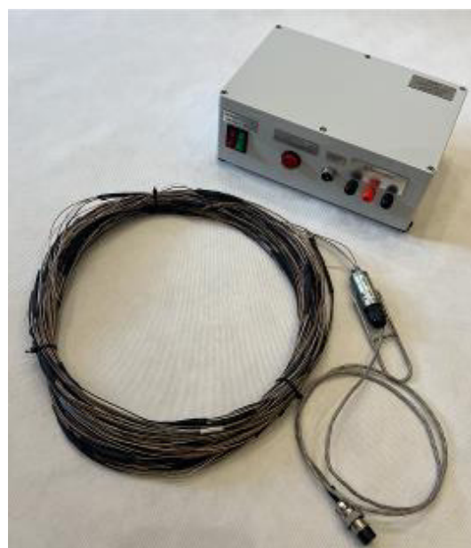
Рисунок 4 – ЦТПТ и пульт для проверки термоподвесок
