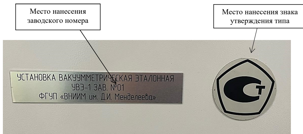
Рисунок 2 – Место нанесения заводского номера и знака утверждения типа установки вакуумметрической эталонной УВЭ-1
