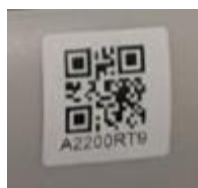
Рисунок 3 – Пример маркировочной таблички контрольно-измерительного устройства с указанием серийного номера и QR-кода. QR-код может отсутствовать
