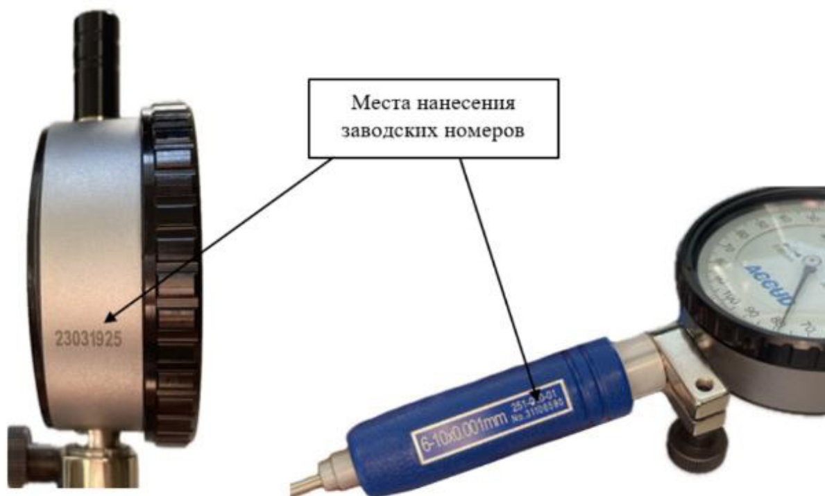
Рисунок 5 – Места нанесения заводских номеров на нутромеры и отсчетные устройства
