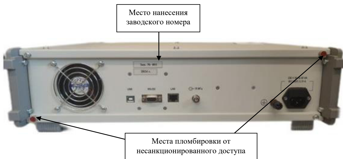
Рисунок 2 – Схема пломбировки от несанкционированного доступа, место нанесения заводского номера
