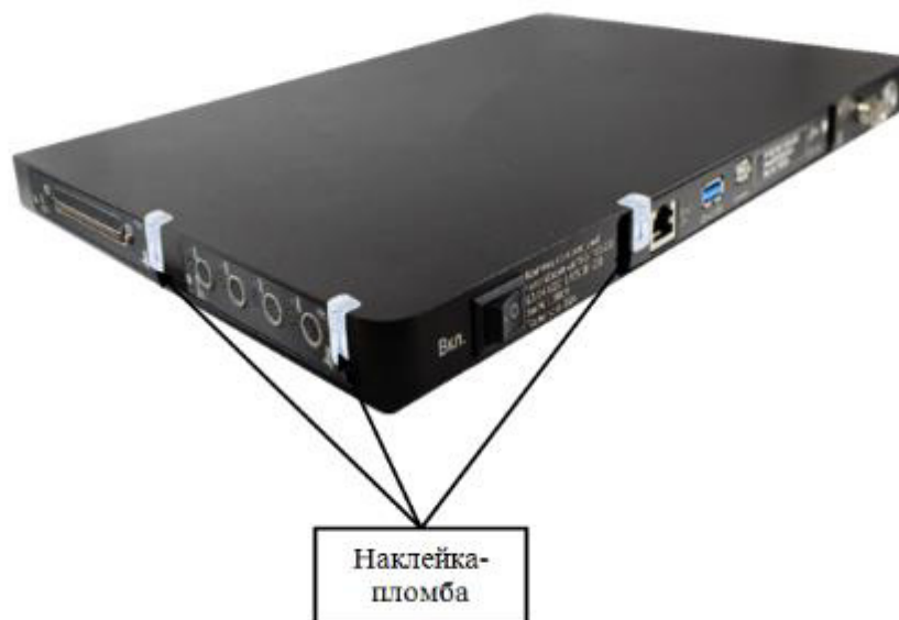
Рисунок 7 – Варианты установки пломбировочных наклеек на комплекс МІС-1155-200 исполнения УХЛ4 (БЛИЖ.422213.155.001-200)
