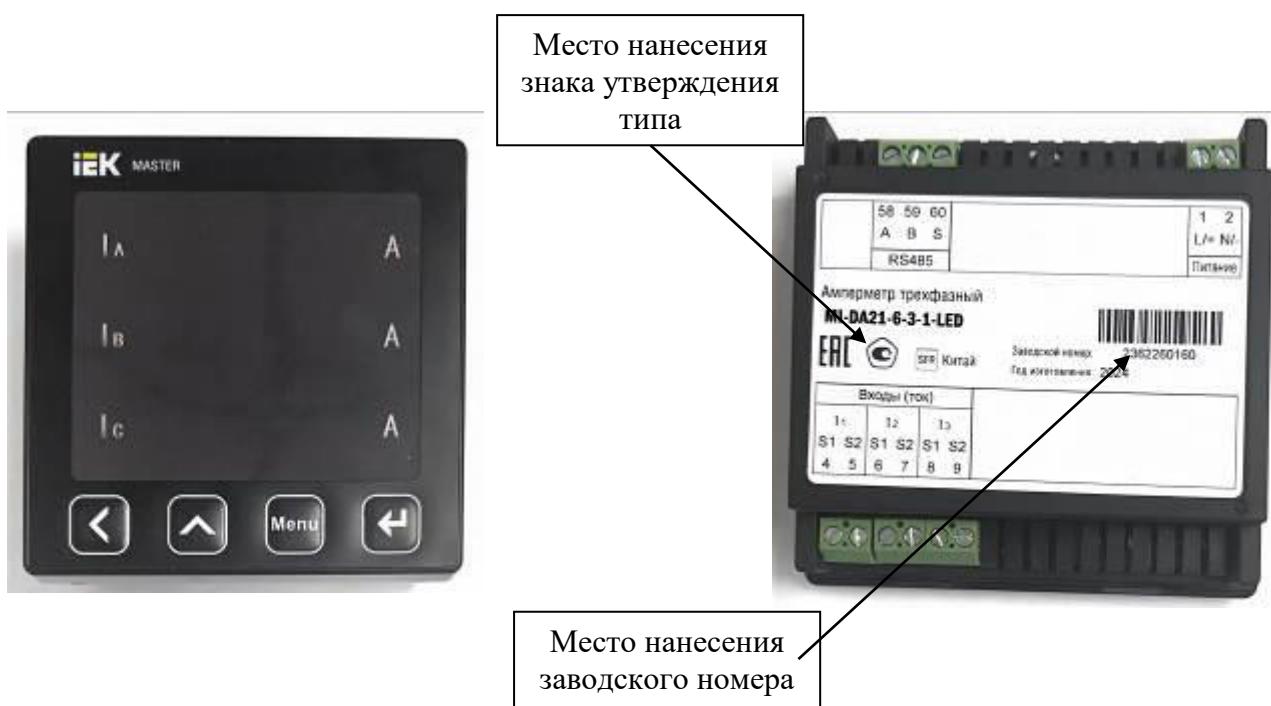
в) общий вид трехфазных амперметров г) места нанесения знака утверждения типа и заводского номера трехфазных амперметров
