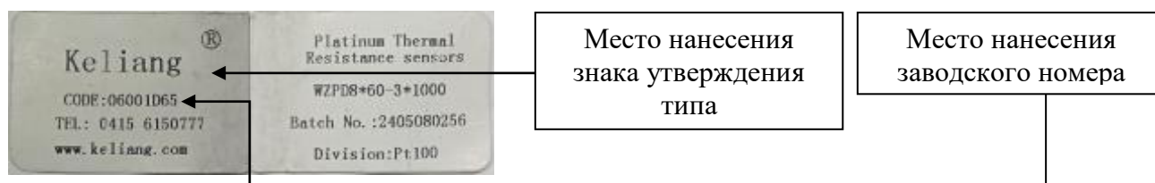
Рисунок 2 – Пример оформления маркировочной наклейки с указанием мест нанесения заводского номера и знака утверждения типа
