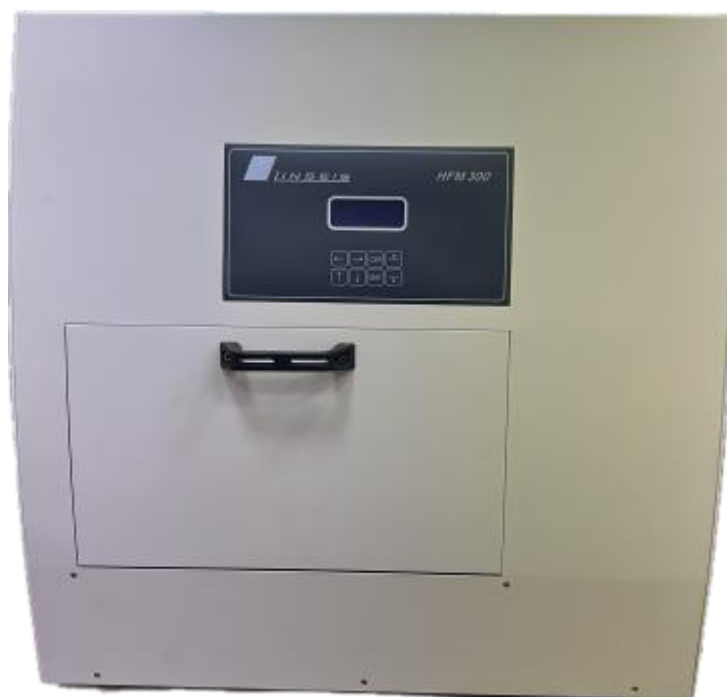
Рисунок 1 – Общий вид приборов для измерения теплопроводности HFM 300 модификации HFM300v1
