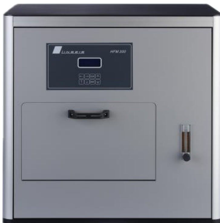
Рисунок 2 – Общий вид приборов для измерения теплопроводности HFM 300 модификации HFM300v2
