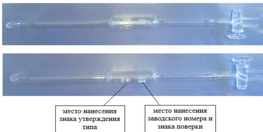
Рисунок 1 – Общий вид бюретки Гемпеля с местами нанесения знака утверждения типа, знака поверки и заводского номера
