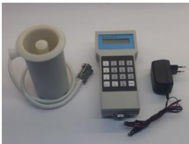
Рисунок 2 – Внешний вид анализатора в исполнении МЦФА.414613.001-01 с наливным датчиком объёмом 230 мл
