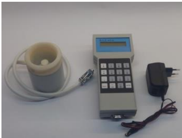
Рисунок 1 – Внешний вид анализатора в исполнении МЦФА.414613.001 с выносным наливным/насыпным датчиком объёмом 125 мл
