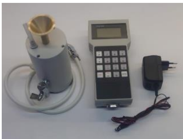
Рисунок 8 – Внешний вид анализатора в исполнении МЦФА.414613.001-07 с датчиком-воронкой объёмом 200 мл
