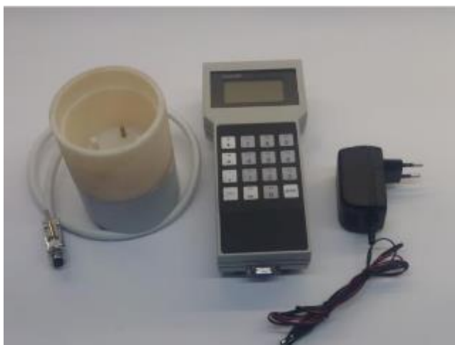
Рисунок 7 – Внешний вид анализатора в исполнении МЦФА.414613.001-06 с наливным/насыпным датчиком объёмом 200 мл
