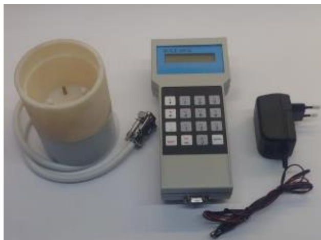
Рисунок 3 – Внешний вид анализатора в исполнении МЦФА.414613.001-02 с наливным/насыпным датчиком объёмом 200 мл
