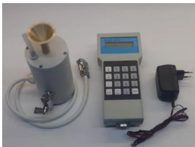
Рисунок 4 – Внешний вид анализатора в исполнении МЦФА.414613.001-03 с датчиком-воронкой объёмом 200 мл
