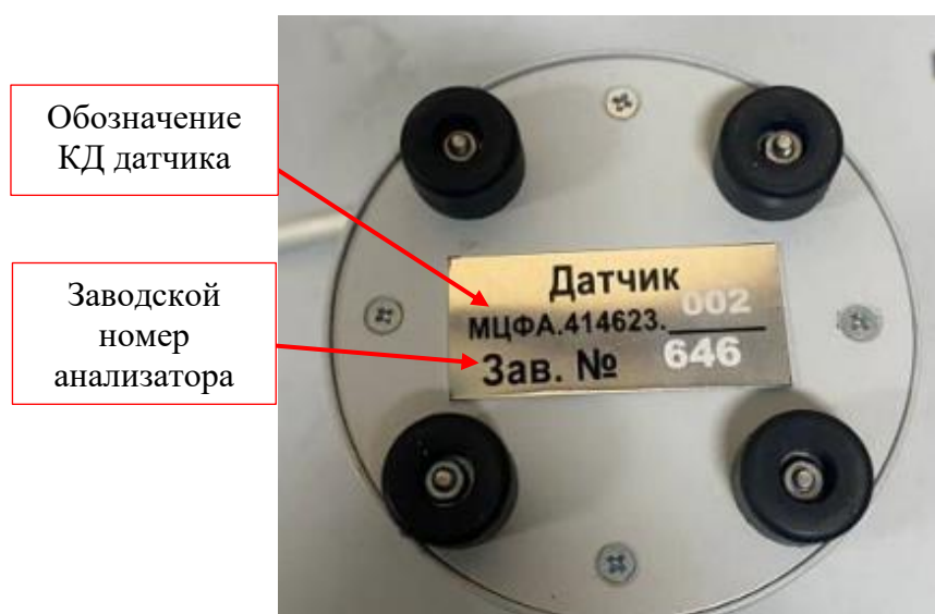
Рисунок 13 – Внешний вид шильдика датчика анализатора с указанием места нанесения заводского номера анализатора
