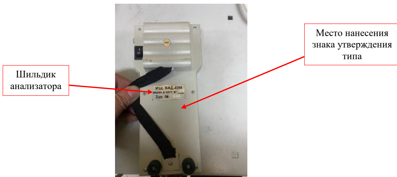
Рисунок 11 – Внешний вид блока управления анализатора с указанием мест нанесения шильдика и знака утверждения типа, вид сзади
