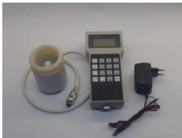
Рисунок 5 – Внешний вид анализатора в исполнении МЦФА.414613.001-04 с выносным наливным/насыпным датчиком объёмом 125 мл
