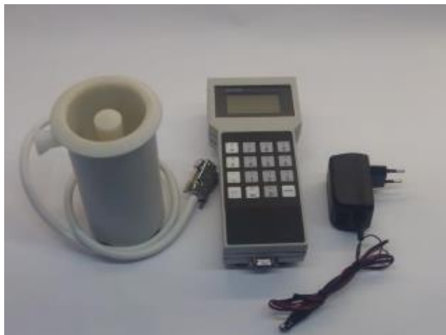
Рисунок 6 – Внешний вид анализатора в исполнении МЦФА.414613.001-05 с наливным датчиком объёмом 230 мл
