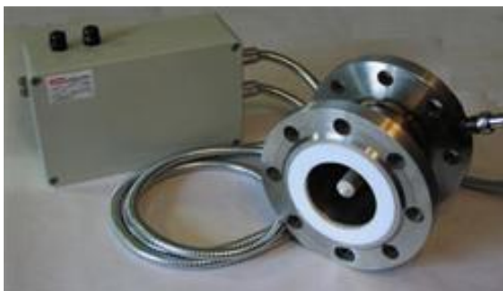
Рисунок 10 – Внешний вид анализатора в исполнении МЦФА.414613.001-09 с проточным датчиком
