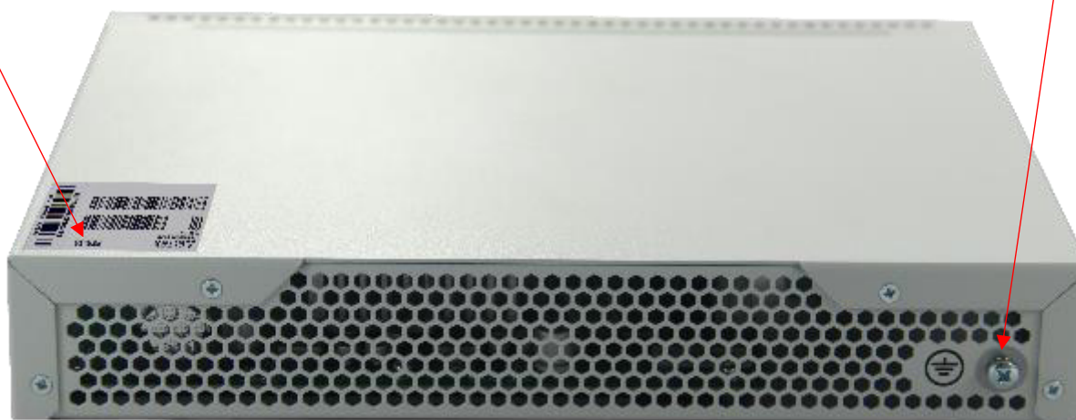
Рисунок 2 – Внешний вид задней панели зонда ESR-30 KMUT
