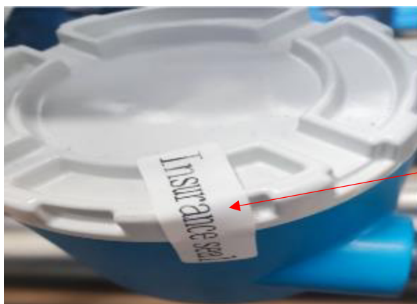
Рисунок 2 – схема пломбировки расходомеров
