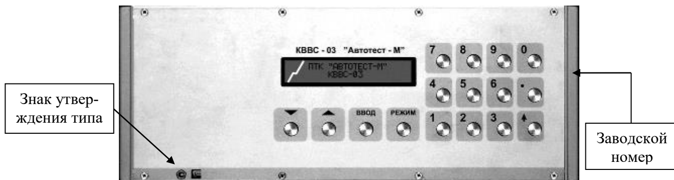
Рисунок 2 – Общий вид контроллеров КВВС спереди (на примере КВВС-03.хх) и места нанесения заводского номера и знака утверждения типа
