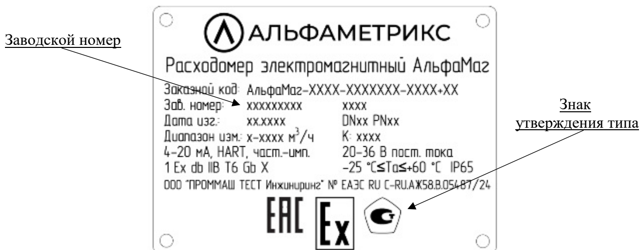
Рисунок 2 – Места нанесения заводского номера и знака утверждения типа на маркировочную табличку
