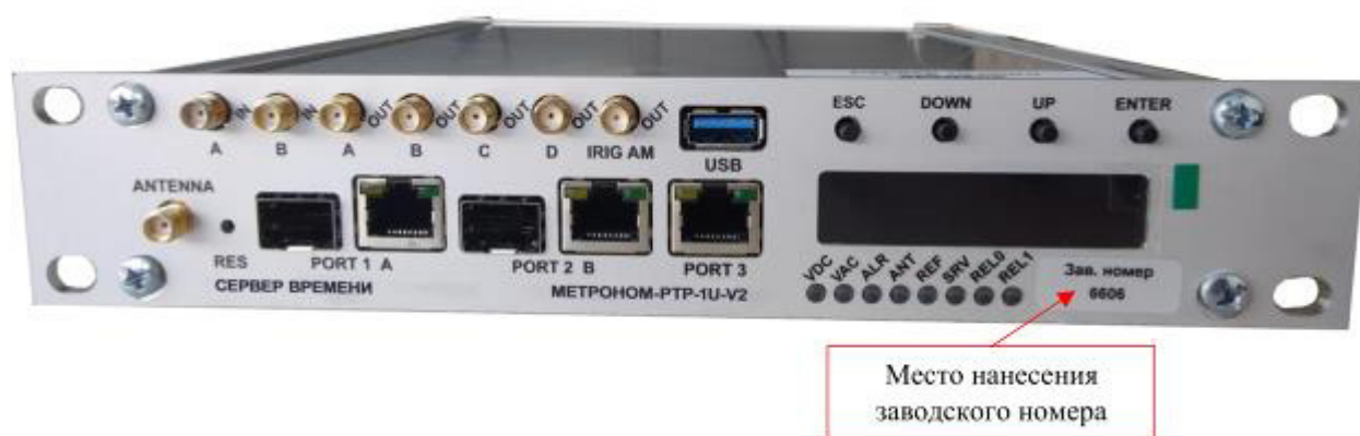
Рисунок 3 – Передняя панель сервера времени Метроном-PTP-1U-V2 с обозначениями разъемов
