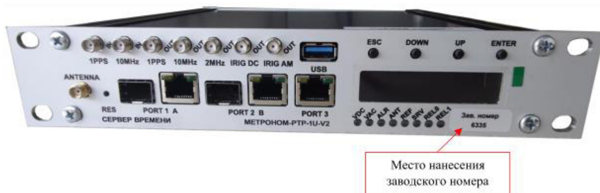
Рисунок 4 – Передняя панель сервера времени Метроном-PTP-1U-V2 с обозначениями разъемов
