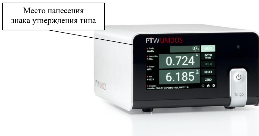
Рисунок 1 – Электрометр UNIDOS Tango 10052
