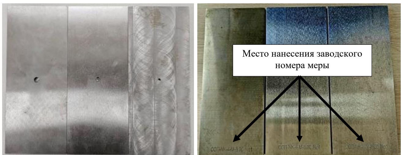
Рисунок 1 – Общий вид и места маркировки комплектов мер
