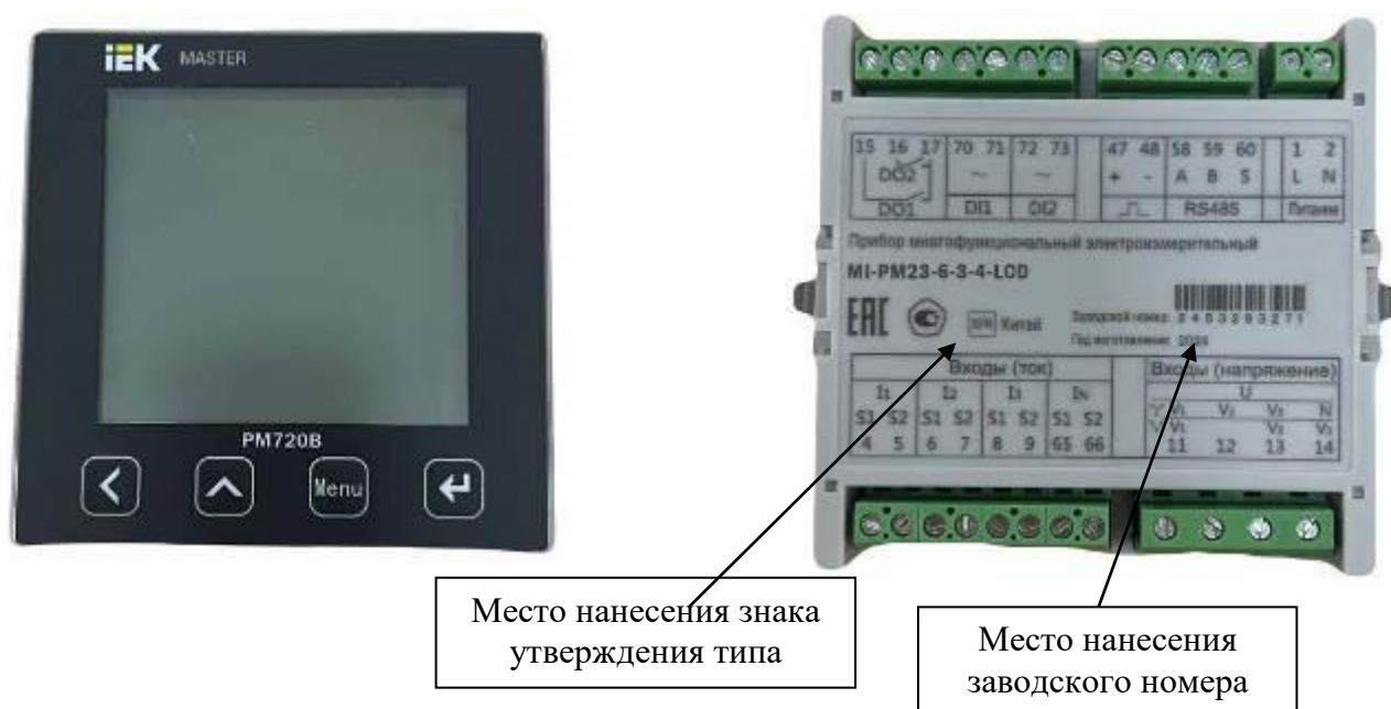
Рисунок 1 – Общий вид приборов с указанием места нанесения знака утверждения типа, места нанесения заводского номера
