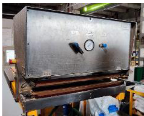
б) Сварочный аппарат для запаивания наполняемого контейнера
