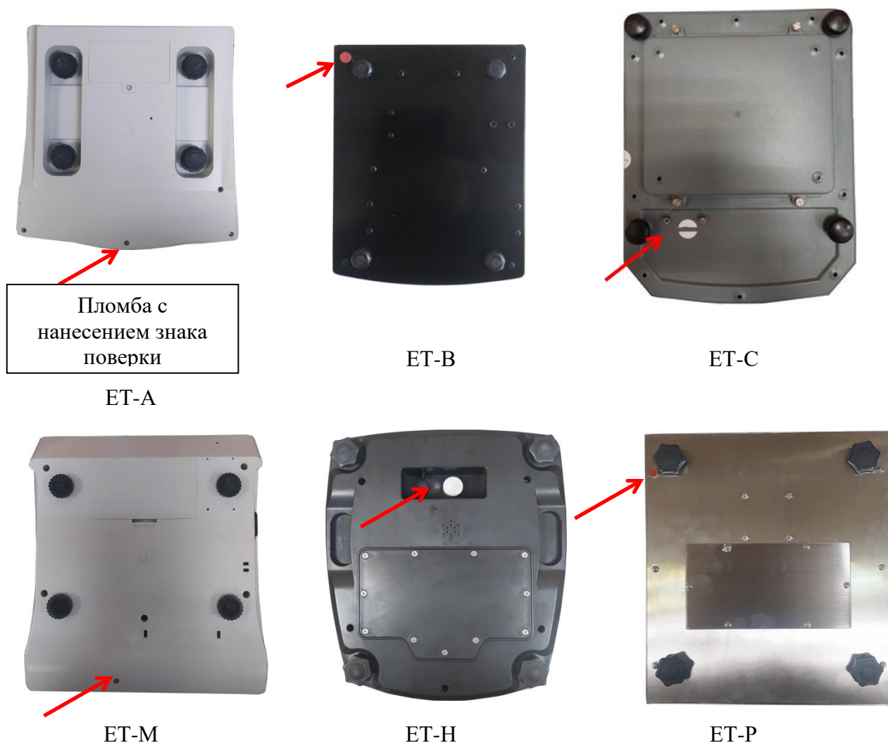
Рисунок 3 – Общий вид снизу весов с указанием места ограничения доступа к местам настройки (регулировки)
