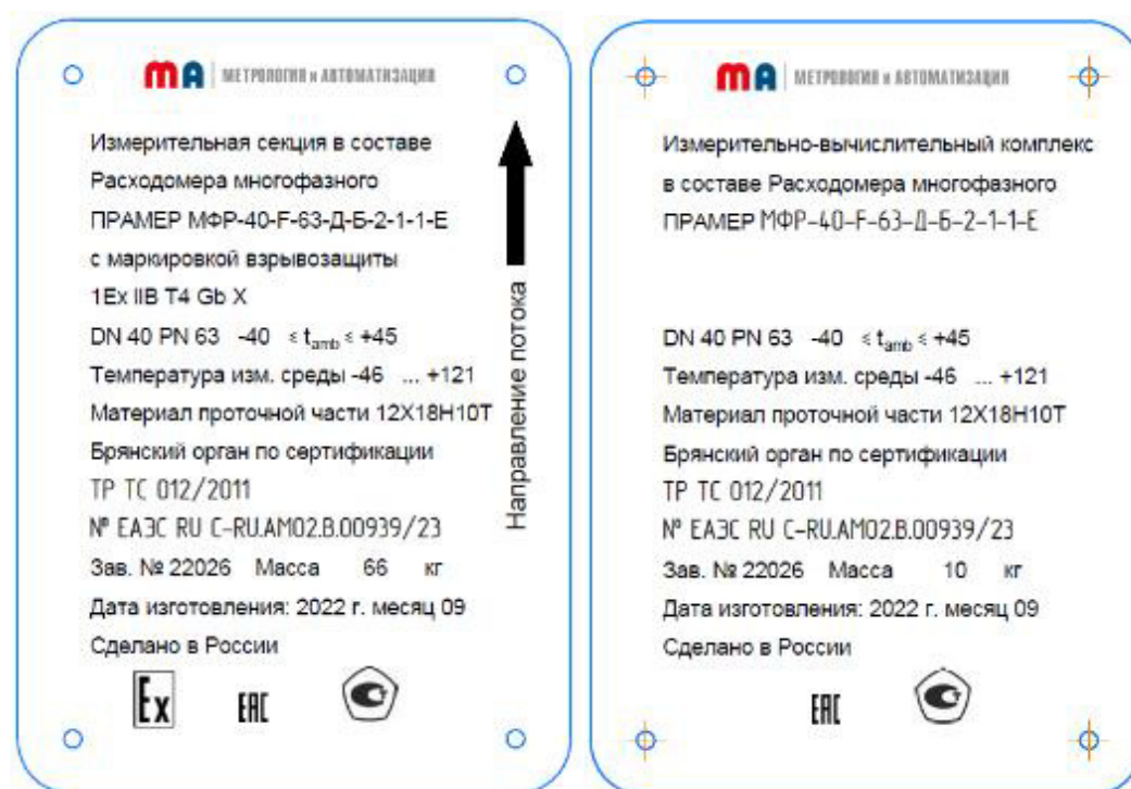
Рисунок 3 – Общий вид маркировочной таблички для ИС и ИВК МФР ПРАМЕР
