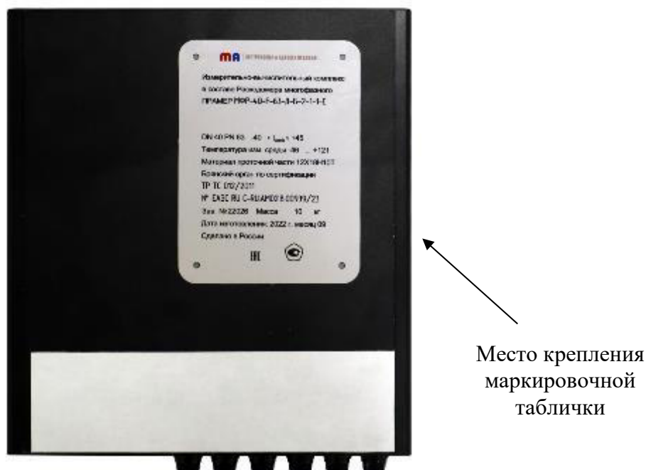
Рисунок 2 – Общий вид ИВК МФР ПРАМЕР с указанием места крепления маркировочной таблички
