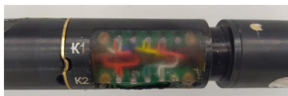
Рисунок 4 – Пример пломбировки электронных компонентов МИ-601
