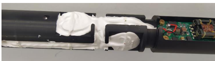
Рисунок 4 – Пример пломбировки электронных компонентов МИ-601
