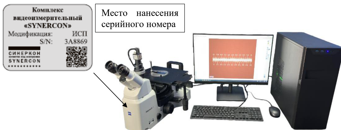
Рисунок 1 – Общий вид комплекса видеоизмерительного SYNERCON модификации ИСП на базе микроскопа плоского поля инвертированного типа и место нанесения серийного номера
